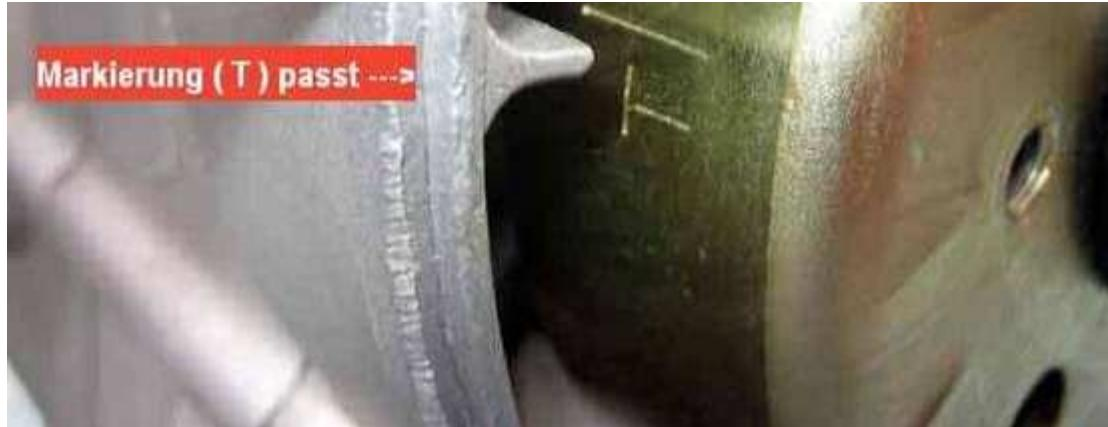
Jetzt steht auch das Nockenwellenrad auf der optimalen Position. Beide kleinen Löcher und die eingravierten Linien müssen mit der Kante des Zylinderkopfes fluchten. Das grosse Loch muss oben sichtbar sein !
