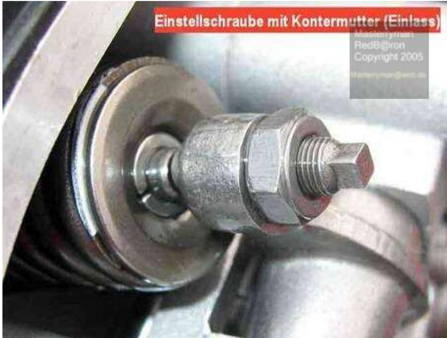
Dann wird der 4-Kant der Einstellschraube vorsichtig so gedreht, dass die passende Lehre sich in den Spalt einschieben lässt. Die Kunst besteht darin, jetzt die Kontermutter wieder so festzudrehen, dass sich das eingestellte Ventilspiel (0,05 und 0,10 mm) nicht wieder verstellt. Dazu sind meist mehrere Versuche notwendig. Zuerst das Einlassventil einstellen, es ist besser zugänglich ! Die Kontermutter nicht zu fest anziehen, das ist ein Feingewinde !
