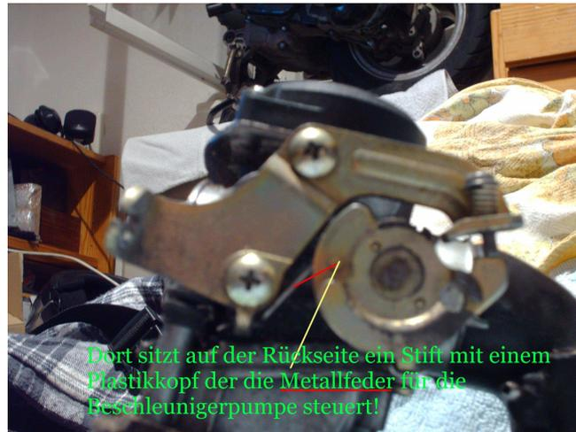
Dort sitzt auf der Rückseite ein Stift mit einem Plastikkopf der die Metallfeder für die Beschleunigerpumpe steuert!
